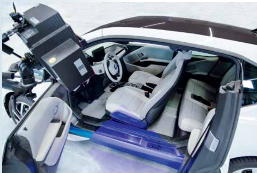
CFK-Interieur-Komponente: optische Messung mit Scanner
