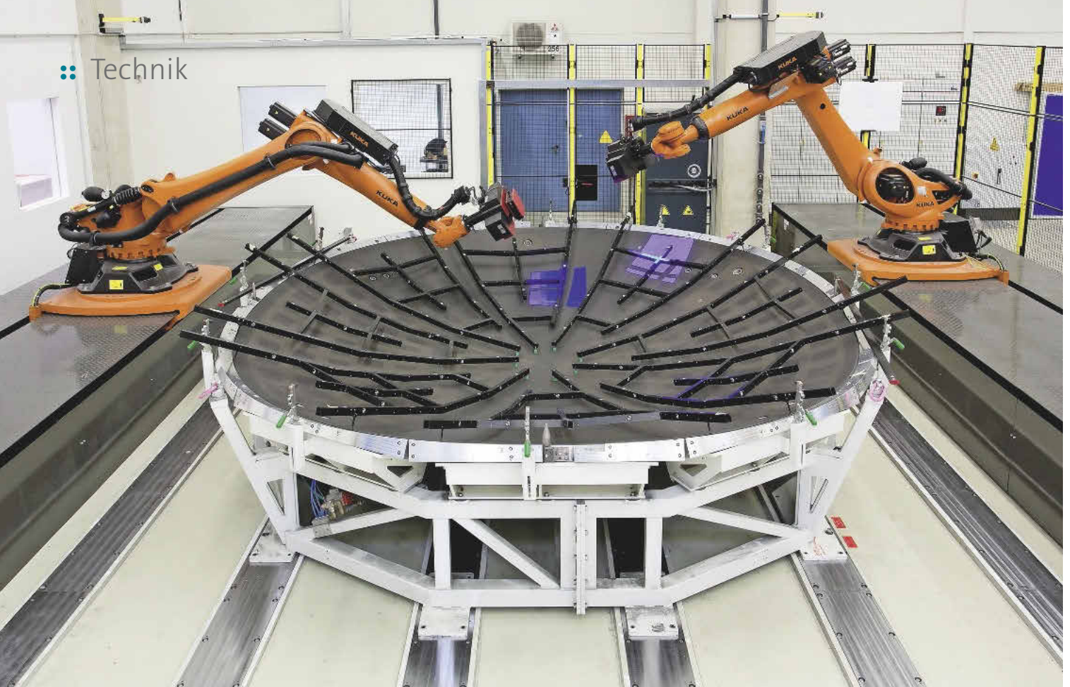
Ein Flugzeugbauteil in einer Doppelständeranlage bei Topometric Bilder: Topometric
