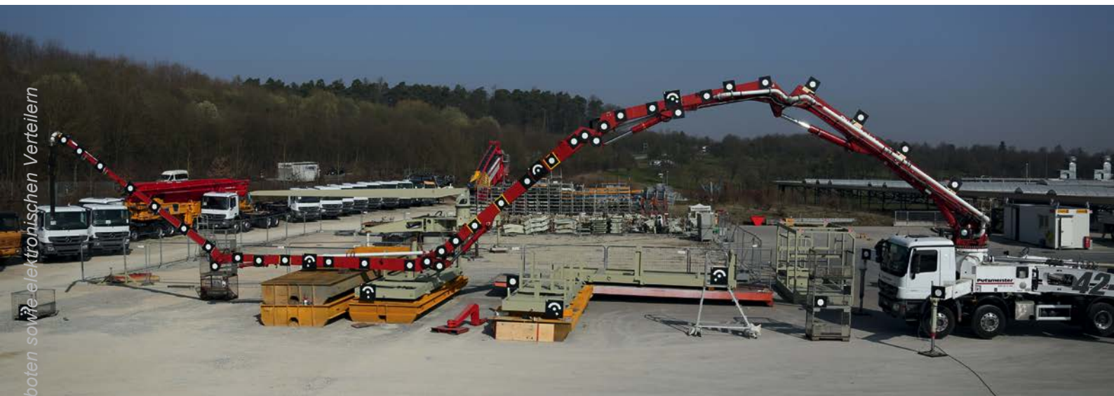
Bild 1. Schwingungsanalysen: Ein 40 Meter langer Baumaschinen-Ausleger wird mit speziellen Messmarken vorbereitet.
