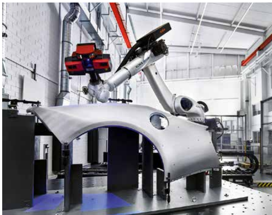
Bild 1. In einer voll automatisierten optischen Roboterzelle mit zwei getrennten Messbereichen können Bauteile in horizontaler oder vertikaler Aufspannung gemessen werden. (© Schuler)
