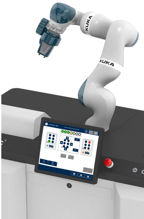
Bild 3: Roboter mit Bedienpanel Robot with operator panel
